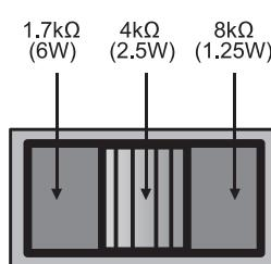
Входной импеданс (подводимая мощность) CS-6/12 определяется положением движкового переключателя.
