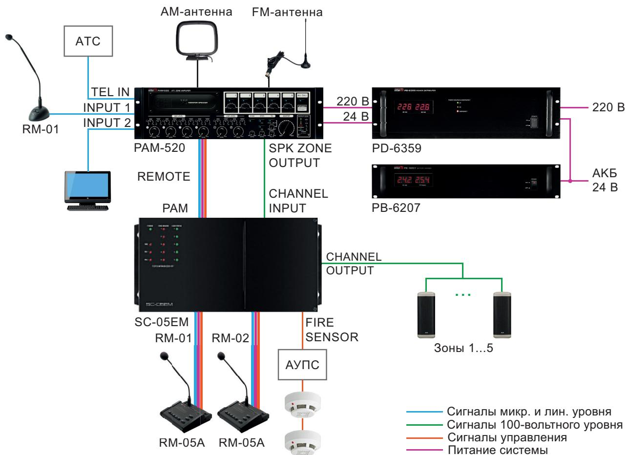
Система автоматического оповещения и музыкальной трансляции
