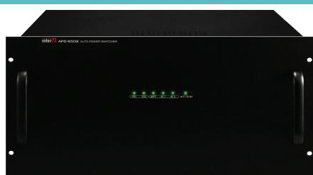
Блок резервирования источников питания предназначен для обеспечения бесперебойного питания в системах оповещения и управления эвакуацией. В комплексе с двумя независимыми источниками переменного напряжения 220 В 50 Гц, двумя блоками контроля и распределения питания PD-6359, аккумуляторными батареями напряжением 24 В, блок APS-6502 поддерживает надежную работу системы в аварийных ситуациях.
