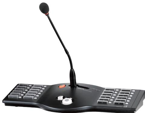
Микрофонная панель имеет селектор зон, включающий 24 кнопки с индикаторами и информационными табличками. С помощью не более двух дополнительных клавиатур RM-6012KP количество таких кнопок может быть увеличено до 48.
