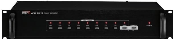
Блок AFD-6218 предназначен для контроля и резервирования 8-ми усилителей мощности в трансляционных системах. В устройстве предусмотрены 8 линейных входов для подключения источников линейного сигнала, 9 линейных выходов для подключения усилителей мощности, 9 входов для подключения 100В линий от усилителей мощности и 8 выходов для подключения трансляционных линий, автоматический и ручной режимы, дистанционный контроль и мониторинг блока.
