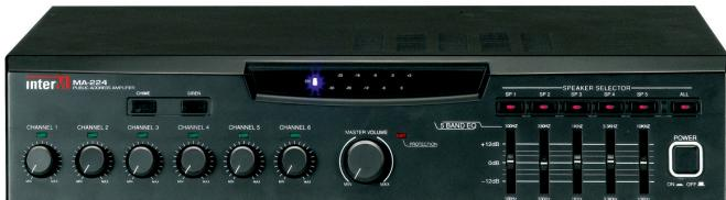
Микшер-усилитель MA-206/212/224 предназначен для построения многоゾоновых систем оповещения. Устройство имеет 5 универсальных входов, 1 линейный вход, вход ATC, клавиши селектора зон, пятиполосный эквалайзер, общий регулятор уровня сигнала MASTER, индикаторы уровня выходного сигнала, наличия питания, наличия сигнала на входах усилителя-микшера, срабатывания защиты. Присутствуют две клавиши сигналов ГОНГ и СИРЕНА. Вход ATC и универсальные входы 1-2 являются приоритетными.
