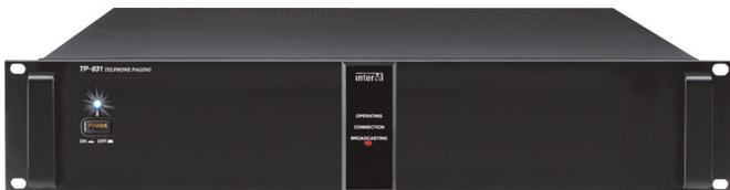
Телефонный контроллер предназначен для сопряжения системы оповещения с телефонной линией. В устройстве предусмотрены возможности работы с 2-х и 4-х проводными телефонными линиями, доступ к системе по паролю, управление режимами работы в тоновом режиме с помощью DTMF сигналов, линейный симметричный выход, клеммы для включения зон оповещения, выход 220 В 50 Гц. Блок предназначен для совместного использования с контроллером ECS-616.
