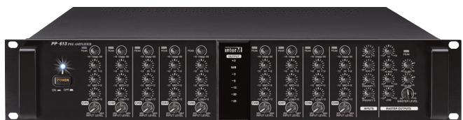
Предварительный усилитель-микшер предназначен для смешивания и согласования сигналов от различных источников. В устройстве предусмотрены 6 моно и 3 стерео универсальных входов (входы Mic1 и 2 линейных входа являются приоритетными), независимая регулировка уровня входного сигнала для каждого канала, 3-х полосный эквалайзер для каждого канала, светодиодная индикация наличия сигнала и перегрузки, основной симметричный выход, 2 дополнительных выхода и выход для записи.
