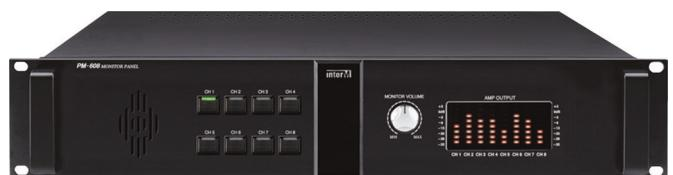
Блок монитора предназначен для контроля 8 независимых линий трансляции напряжением 100 В. В устройстве предусмотрены светодиодные 10-уровневые индикаторы для визуального контроля уровня сигнала в каждой линии, селектор контролируемых линий, громкоговоритель для прослушивания одной из них и регулятор громкости прослушивания.
