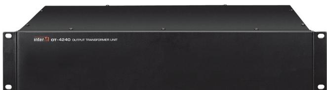
Блок трансформаторов предназначен для гальванической развязки и согласования трансляционных линий и усилителей мощности в системах оповещения и музыкальной трансляции. Блок OT-4240/4480/4960 применяется совместно с усилителями QD-4240/4480/4960 соответственно.
