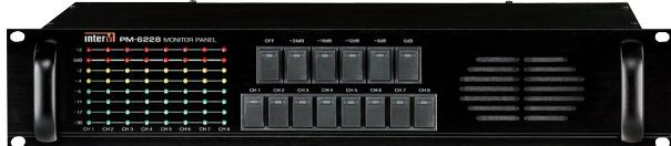
Блок мониторинга аудиосигналов PM-6228 предназначен для визуального и акустического контроля сигналов на 8-ми трансляционных линиях напряжением 100 В. В устройстве предусмотрен 8-сегментный светодиодный индикатор, встроенный громкоговоритель для прослушивания линии и регулятор громкости воспроизведения.
