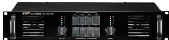
Блок монитора LM-6228 предназначен для визуального и акустического контроля сигналов оповещения и музыкальной трансляции линейного уровня. В устройстве предусмотрены 8 симметричный входов и выходов, светодиодный индикатор для визуального контроля уровня сигнала, встроенные громкоговорители для прослушивания каналов, кнопки выбора канала прослушивания и регулятор громкости воспроизведения.
