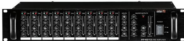
Предварительный усилитель-микшер PP-6213 предназначен для применения в системах звуковоспроизведения и позволяет смешивать и согласовывать аудиосигналы от различных источников. В устройстве предусмотрено 9 универсальных, 2 дополнительных линейных и 2 приоритетных линейных входа, 3-х полосный эквалайзер для каждого универсального входа, 4-х полосный эквалайзер для выхода, основной симметричный выход и 2 дополнительных линейных выхода.
