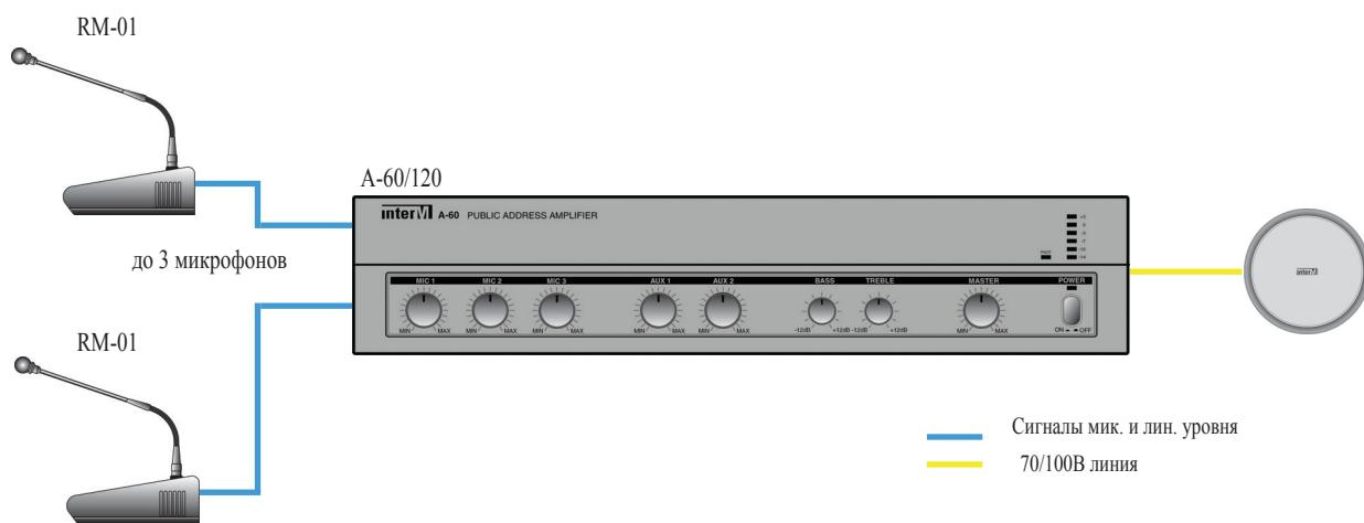
Система имеет 1 зону трансляции общей мощностью 60/120 Вт. Музыкальная трансляция обеспечивается подключением к линейным входам усилителя внешних источников. Речевые сообщения подаются с помощью микрофонов, подключенных к микрофонным входам А-60/120.
