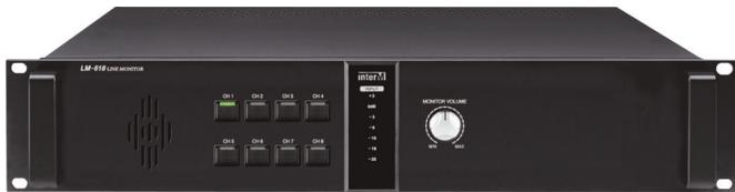
Блок монитора предназначен для контроля сигналов оповещения и музыкальной трансляции линейного уровня. В устройстве предусмотрены светоиздийный 7-уровневый индикатор для визуального контроля уровня сигнала в каждом канале, селектор контролируемых каналов, громкоговоритель для прослушивания одного из них и регулятор громкости прослушивания.
