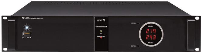
Блок контроля и распределения питания предназначен для обеспечения установленного в стойку оборудования напряжениями 220 и 24 В. В устройстве предусмотрена возможность дистанционного включения, 2 неотключаемые и 3 отключаемые розетки 220 В 50 Гц, выходы 24 В пост. тока, вход для подключения блока аккумуляторных батарей (резервное питание), автоматический переход на резервное питание при пропадании напряжения 220 В 50 Гц, цифровые вольтметры переменного и постоянного напряжения.
