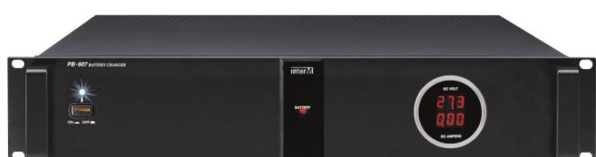
Зарядное устройство предназначено для поддержания блока аккумуляторных батарей в заряженном состоянии. В блоке предусмотрены индикация напряжения и тока заряда, защита от перезаряда и превышения тока заряда. Устройство применяется в системах оповещения в составе стоечного оборудования и рассчитано на работу с блоком аккумуляторов общим напряжением 24 В.
