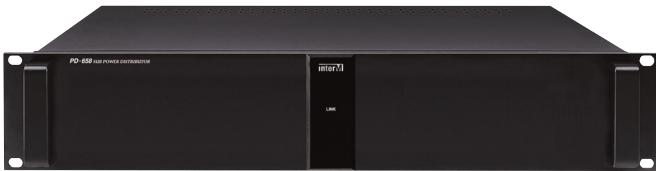
Блок расширения распределителя питания предназначен для обеспечения установившегося в стойку оборудования напряжением 220 В. В устройстве предусмотрены 6 отключаемых розеток 220 В 50 Гц. Блок используется совместно с блоком PD-659.
