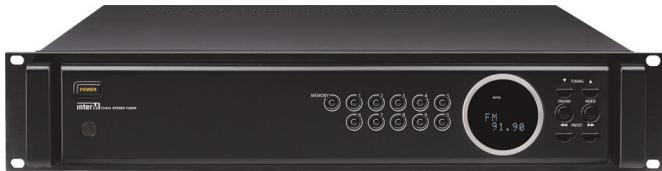
Цифровой стереотюнер предназначен для приема сигналов радиостанций и используется в составе стоечного оборудования для музыкальной трансляции. В устройстве предусмотрены автоматический поиск станции, автоматическое шумоподавление, память на 40 станций и возможность удаленного управления с помощью пульта RC-100.
