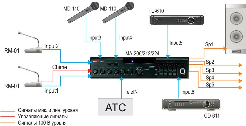
Система музыкальной трансляции и оповещения на 5 зон, построенная с применением микшер-усилителя MA-206/212/224, позволит озвучить различные офисные помещения, залы, открытые площадки.
