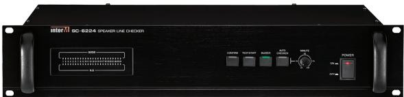
SC-6224 осуществляет контроль до 24 трансляционных линий с сопротивлениями в диапазоне от 20 Ом до 3 кОм. Блок может распознавать обрыв трансляционной линии, короткое замыкание и изменение импеданса на 10 или 20 %, сопровождая эти состояния звуковой и световой индикацией. С помощью ПК и соответствующего программного обеспечения возможен удаленный контроль состояния и режима работы блока, а также выполнение оперативной проверки трансляционных линий.
