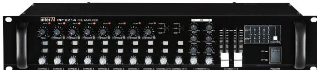
Предварительный усилитель-микшер PP-6214 предназначен для применения в системах звукоспроизведения и позволяет смешивать и согласовывать аудиосигналы от различных источников, имеет 2 группы микширования и 2 симметричных выхода. В устройстве предусмотрено 1 приоритетный микрофонный вход, 7 универсальных входов, 2 линейных стерео-входа и 2 приоритетных линейных входа, 3-х полосный эквалайзер для каждого выхода и 2 дополнительных линейных выхода.
