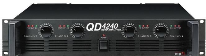
Четырехканальный усилитель предназначен для усиления сигналов звуковой частоты линейного уровня. По каждому входу имеется регулятор уровня сигнала. В усилителе предусмотрена защита от превышения температуры и постоянного напряжения на выходе, а также светодиодная индикация наличия сигнала, перегрузки, срабатывания защиты для каждого канала.
