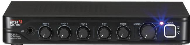
Компактный цифровой микшер-усилитель предназначен для построения однозоновых систем оповещения. В устройстве предусмотрены микрофонный, универсальный, линейный вход, вход АТС, двухполосный эквалайзер, светодиодные индикаторы наличия уровня входного сигнала и питания. Микрофонный вход и вход АТС являются приоритетными. Усилитель формирует выходное напряжение 70 и 100 В. Имеется выход для подключения нагрузки сопротивлением 4 Ом.
