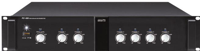
Блок предназначен для распределения сигнала линейного уровня от одного источника на несколько усилителей мощности. В устройстве предусмотрены симметричный вход для подключения источника сигнала линейного уровня, 6 симметричных выходов для подключения усилителей мощности, регуляторы уровня входного сигнала, регуляторы уровня выходного сигнала для каждого канала, светодиодные индикаторы наличия сигнала на входе и каждом из выходов.
