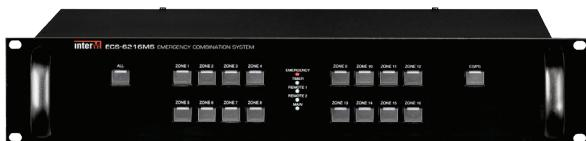
Блок расширения ECS-6216MS отвечает за сопряжение многоканальной системы с охранным-пожарной сигнализацией и предназначен для подключения зон оповещения к контроллеру PX-6216 и увеличению зон в системе оповещения до 160. Релейный модуль устройства позволяет организовать трехпроводные линии, которые используются при подключении аттенюаторов ATT-03 и ATT-30.
