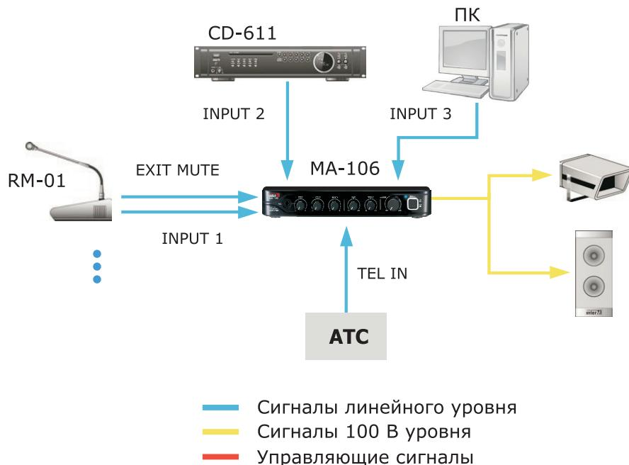
Система музыкальной трансляции и оповещения на 1 зону,строенная с применением микшер-усилителя MA-106, позволит озвучить небольшие помещения (залы, площадки, дворы).
