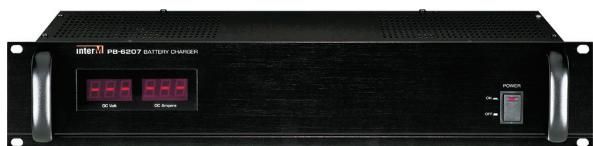
Зарядное устройство PB-6207 предназначено для поддержания в заряженном состоянии аккумуляторных батарей резервного питания общим напряжением 24В, используемых в системе оповещения и звуковой трансляции. В блоке предусмотрены индикация напряжения и тока заряда батарей. Удаленный мониторинг и контроль работы зарядного устройства осуществляется по общему внутреннему интерфейсу RS-485.
