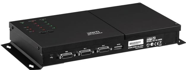
Блок SC-05EM предназначен для построения систем оповещения и музыкальной трансляции и выполняет функции: контроллера системы, маршрутизатора тревожного оповещения и источника сообщений. А также позволяет передавать голосовые сообщения в выбранные зоны и обеспечивает контроль целостности трансляционных линий. На основе SC-05EM можно построить 5-ти зонную систему оповещения 3 – 5 типа.
