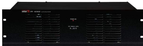
Автоматический вентилятор предназначен для поддержания нормального температурного режима оборудования, установленного в 19-дюймовый аппаратный шкаф. Устройство имеет 2 вентилятора, автоматический и ручной режимы работы, встроенный термодатчик с порогом срабатывания 35 градусов Цельсия.
