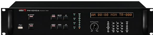
Программируемый таймер PW-6242A предназначен для воспроизведения по недельному расписанию голосовых сообщений и музыкальных сигналов. Кроме этого, согласно расписанию, таймер позволяет управлять электропитанием различных устройств. PW-6242A имеет внутреннюю память для хранения до 15-ти MP3-файлов, объемом 1 Гб и дополнительно может через интерфейс RS-232 управлять режимом воспроизведения цифрового магнитофона PV-6232.
