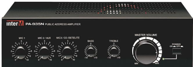
Микшер-усилитель предназначен для создания систем оповещения малой мощности. В устройстве предусмотрены приоритетный микрофонный вход, 2 универсальных входа, линейный вход для подключения АТС, регуляторы громкости для каждого входа, 2-полосный эквалайзер. Усилитель формирует выходное напряжение 70 и 100 В. Имеются выходы для подключения нагрузки сопротивлением 4 и 8 Ом.
