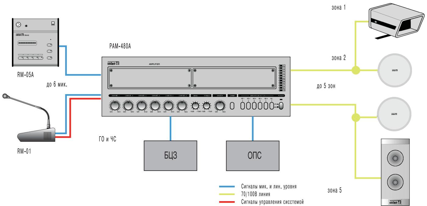
Система автоматического оповещения и музыкальной трансляции
