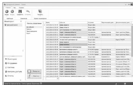
Бесплатная версия программного обеспечения Timex Free предназначена для реализации системы контроля доступа с использованием контроллеров серии ST-NCxxxxx и биометрических считывателей для автоматического контроля пропускного режима и управления исполнительными устройствами (замками, турникетами, шлагбаумами, воротами, лифтами, и т. д.) в соответствии с заданными уровнями доступа и временными зонами.
