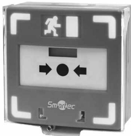
Устройство разблокировки дверей (УРД) ST-ER116TLS-GN рекомендуется к использованию для разблокировки электрически управляемых замков в экстренных случаях с внутренней стороны на выход, например, при эвакуации людей. Восстанавливаемая кнопка активации позволяет быстро и без дополнительных расходов (замена при использовании стеклянных вставок) восстановить нормальный режим эксплуатации дверей после осуществления эвакуации.
