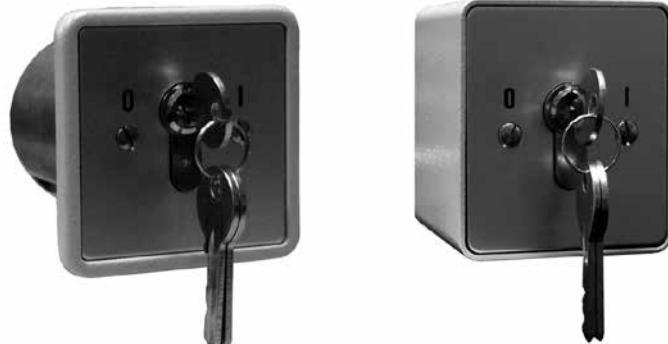
Устройства разблокировки дверей (УРД) серии ST-ES120 рекомендуются к использованию для разблокировки электрически управляемых замков с внешней стороны на вход при возникновении нештатных ситуаций или для управления какими-либо исполнительными устройствами. Ключ может изыматься, как в состоянии «включено», так и в состоянии «выключено».
