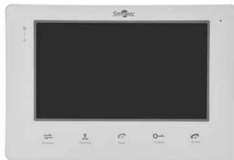
Монитор видеодомофонной связи ST-MS207M-WT используется для реализации односторонней видеосвязи и двухсторонней аудиосвязи с панелями вызова по 4-х проводной линии. Обладая широкими функциональными возможностями, этот монитор поддерживает сохранение фото и видео: при вызове с внешней панели, по срабатыванию внешних охранных датчиков или по команде пользователя.
