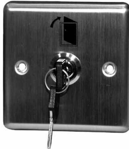
Устройство разблокировки дверей (УРД) ST-ES110 рекомендуется к использованию для разблокировки электрически управляемых замков с внешней стороны на вход при возникновении нештатных ситуаций или для управления какими-либо исполнительными устройствами. Ключ может изыматься, как в состоянии «включено», так и в состоянии «выключено».
