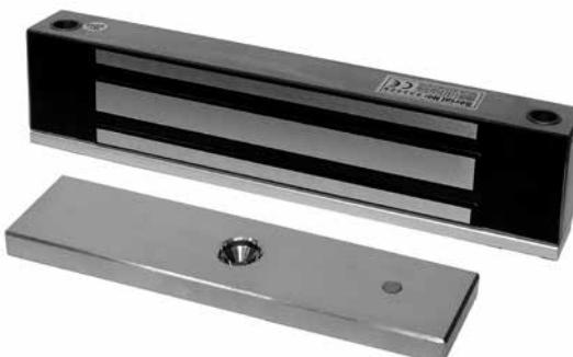
Электромагнитные замки ST-EL360W имеют силу удержания, равную 360 кг, и применяются для управляемого запирания и отпирания дверей зданий, контролируемых системой управления доступом. Эта модель предназначена для наружного/внутреннего монтажа и может использоваться в офисах, промышленных зданиях, супермаркетах и на др. объектах
