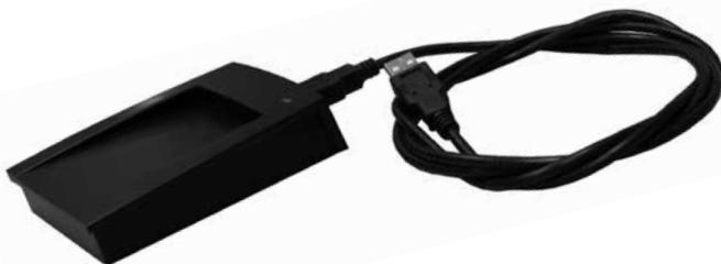
Считыватель ST-CE010EM карт EM может использоваться для ввода номеров карт в различных программных приложениях. Проксимити считыватель подключается к компьютеру через USB порт и определяется системой как HID-совместимое устройство. Он автоматически распознается операционной системой и не требует дополнительной установки драйверов.
