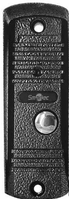
Панель вызова видеодомофонной связи ST-DS104C-GR используется для реализации односторонней видеосвязи и двухсторонней аудиосвязи с мониторами по 4-х проводной линии. Панель вызова оснащена камерой стандартного разрешения и ИК подсветкой, автоматически активирующейся при снижении освещенности. Антивандальный корпус из алюминиевого
