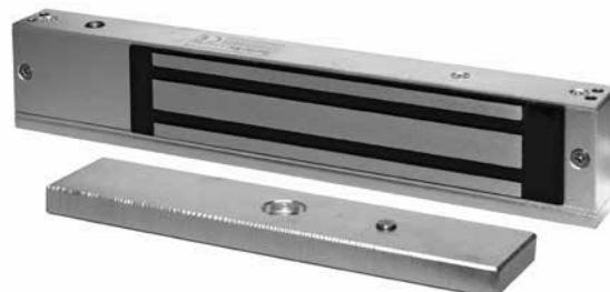
анализирует магнитный поток, т.е. силу притяжения якоря к замку, и сигнализирует о снижении усилия прижима и соответственно о попытке взлома. При этом снижение усилия может быть результатом преднамеренных действий, например, повреждения поверхности якоря для последующего облегчения проникновения в помещение.
