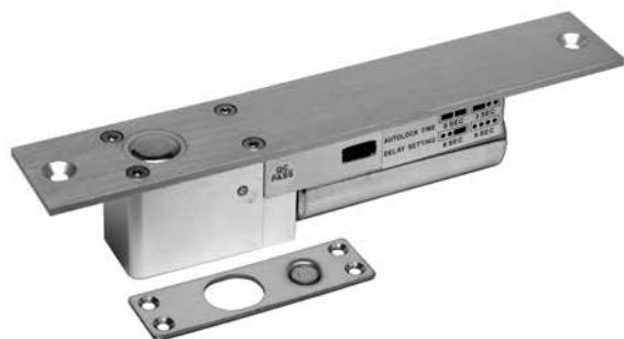
Электромеханический соленоидный замок ST-DB090T предназначен для работы в составе систем контроля доступа с электронным управлением блокировкой дверей. Замок ST-DB090T является нормально-открытым, т.е. разблокируется при отключении питания и блокируется при его наличии. Кроме того, таймер задержки запирания замка, которым оснащен ST-DB090T, позволяет предотвратить преждевременный выход ригеля, пока дверь не остановится в закрытом положении.
