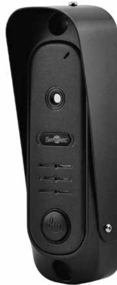
Панель вызова видеодомофонной связи ST-DS206C-BK используется для реализации односторонней видеосвязи и двухсторонней аудиосвязи с мониторами по 4-х проводной линии. Панель вызова оснащена камерой высокого разрешения и ИК подсветкой, автоматически активирующейся при снижении освещенности. Антивандальный корпус из алюминиевого
