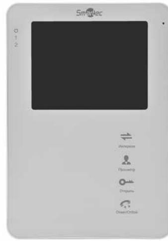
Монитор видеодомофонной связи ST-MS204M-WT используется для реализации односторонней видеосвязи и двухсторонней аудиосвязи с панелями вызова по 4-х проводной линии. Обладая широкими функциональными возможностями, этот монитор поддерживает сохранение фото и видео: при вызове с внешней панели, по срабатыванию внешних охранных датчиков или по команде пользователя.
