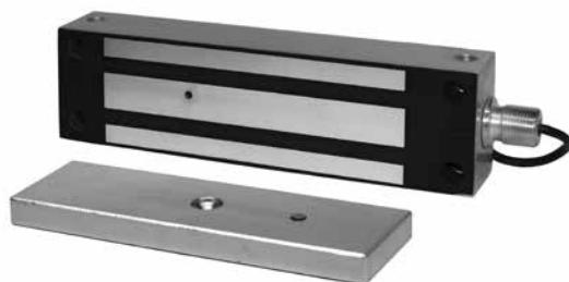
Электромагнитный замок ST-EL500MW обеспечивает удерживающее усилие, равное 500 кг, а благодаря герметичному корпусу, может эксплуатироваться в уличных условиях. Его основное назначение – управляемое запирание / отпирание калиток или ворот. Данная модель имеет встроенный датчик Холла для мониторинга прижима якоря к телу замка. Датчик Холла анализирует магнитный поток, т.е. силу притяжения якоря к замку и сигнализирует о снижении усилия прижима якоря
