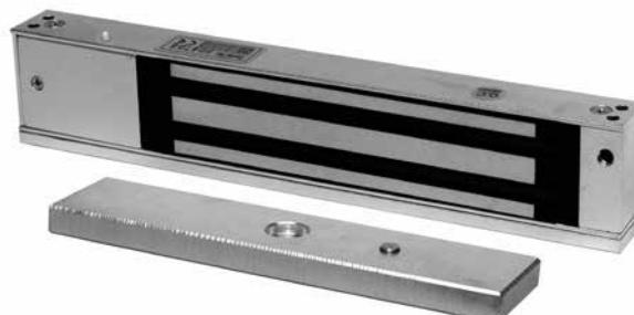
Электромагнитный замок ST-EL270L предназначен для установки на двери, контролируемые СКУД, а также на двери эвакуационных выходов. Одноцветная световая индикация обеспечивает визуализацию различных состояний замка: СИД не горит – нет питания, красный сигнал – на замок подано питание. Для преодоления остаточной намагниченности в устройстве используется специальное цинковое покрытие якоря замка совместно с пружинным механизмом.
