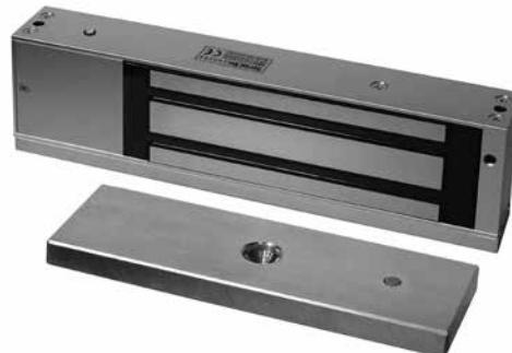
Электромагнитный замок ST-EL500ML предназначен для запирания дверей, контролируемых СКУД, и обеспечивает удерживающее усилие 500 кг. Для преодоления остаточной намагниченности в устройстве используется специальное цинковое покрытие якоря замка совместно с пружинным механизмом. Модель имеет встроенный датчик Холла для мониторинга прижима якоря к телу замка. Датчик Холла анализирует магнитный поток, т.е. силу притяжения якоря к замку,
